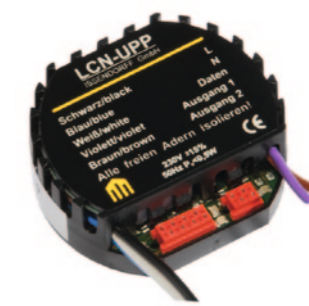
Abb. 23 LCN-UPP-Modul Quelle: Issendorff KG
